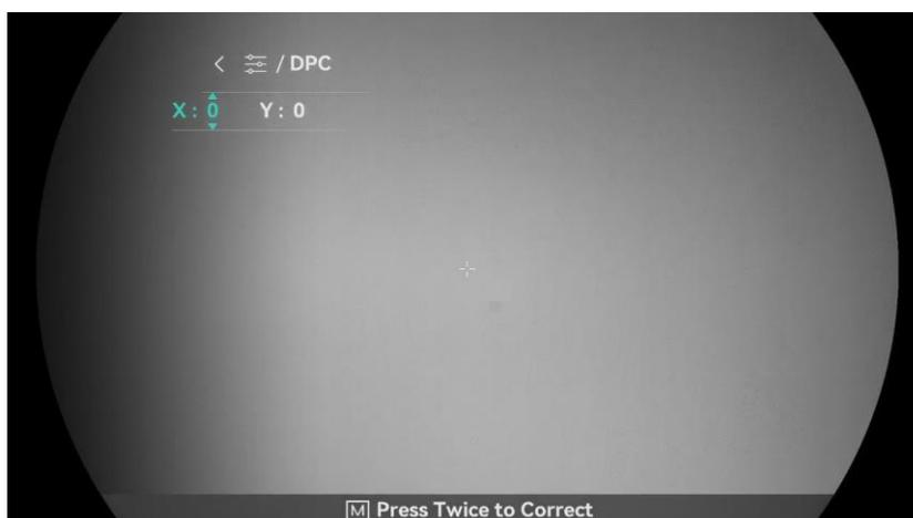
Figura 3-6 Corrección de píxeles defectuosos
